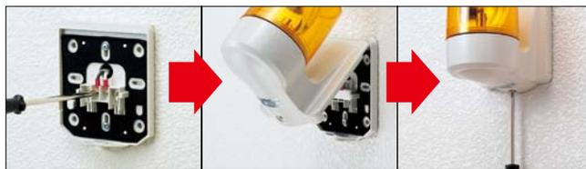
壁面やスイッチボックスに固定プレートをネジで固定し、付属の圧着端子等で端子台に配線します。
