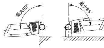
※本体取付方向制限はありません（エネーポジション構造）が、設置条件により上記のように、構造物と干渉します。
