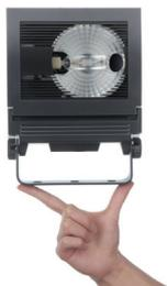
セラルクスト (35W・70W) を採用し、従来品と比べて体積は半分以下の45%を実現しました。本体質量も約2kgと軽量で、高所での取扱いが容易です。器具設置スペースが少なく理想の照明が難しかった場所や、照明器具自体を目立たせたくないサインボードやファサード照明などに適しています。
