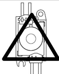
本製品を設置面に取り付けをする際は、設置方向にご注意ください。設置の際は、配線を伝って水滴がモジュールへかからないように、左図のように設置の際に配慮をお願いいたします。
