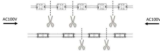
本製品は1個単位で動作します。配線を切断・延長・結線する場合、配線のどの位置で切り離しても動作します。通電は入出力の極性は無く、配線の左右どちらから入力しても動作します。(但し、両側から同時に入力しないでください。 ※ [3. 製品の配線切断]の項参照) また、+、-(L、N)の極性もありません。L、Nをどちらに接続しても動作します。
