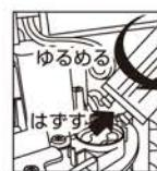
⑥片側の外枠を外してから、グロー球が確認できない場合は、外した外枠を戻してから、本体を回転させて反対側の外枠を外してください。新しいグロー球を差し込み、右方向に止まるまで回して、グロー球を固定します。
