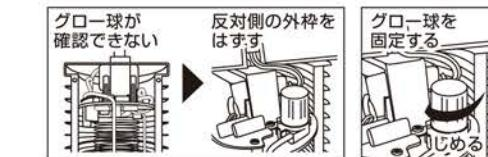
⑦グロー球の交換が終わりましたら、外した外枠を正しい位置に戻します。
