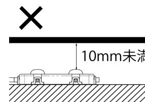
近接照射限度距離(10mm)以内での可燃物への照射
