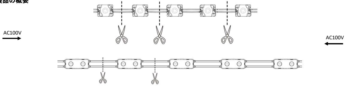
本製品は1個単位で動作します。配線を切断・延長・結線する場合、配線のどの位置で切り離しても動作します。
