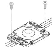
付属の両面テープのみではLEDモジュールの固定はできません。ネジ止めするか、シリコン接着材などで確実に固定してください。
