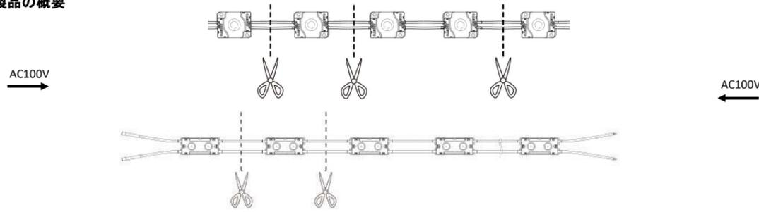
本製品は1個単位で動作します。配線を切断・延長・結線する場合、配線のどの位置で切り離しても動作します。通電は入出力の極性は無く、配線の左右どちらから入力しても動作します。(但し、両側から同時に入力しないでください。※ [3. 製品の配線切断]の項参照) また、+、-(L、N)の極性もありません。L、Nをどちらに接続しても動作します。
