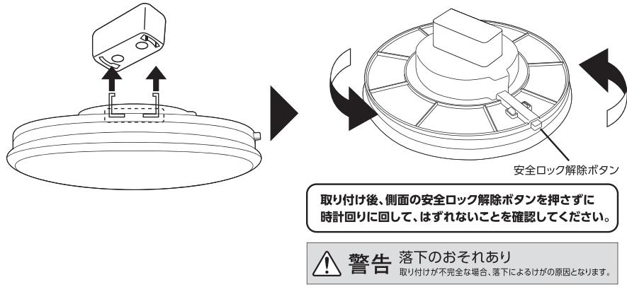
取り付け後、側面の安全ロック解除ボタンを押さずに時計回りに回して、はずれないと確認してください。
