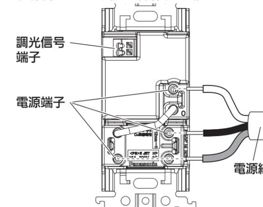
(注) 故障しますので間違っても調光信号端子に電源線を接続しないでください。
