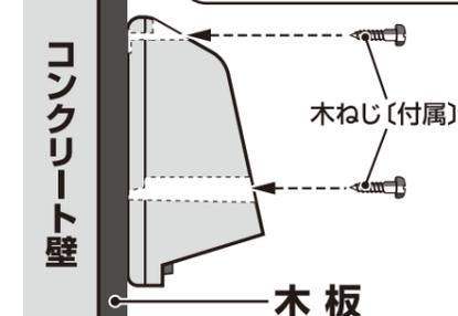
木板を使用して取り付けてください。木板は、コンクリート釘または接着剤などで堅固に固定してください。
