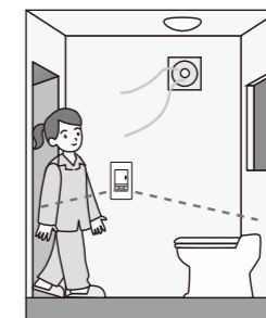
照明も換気扇もON
