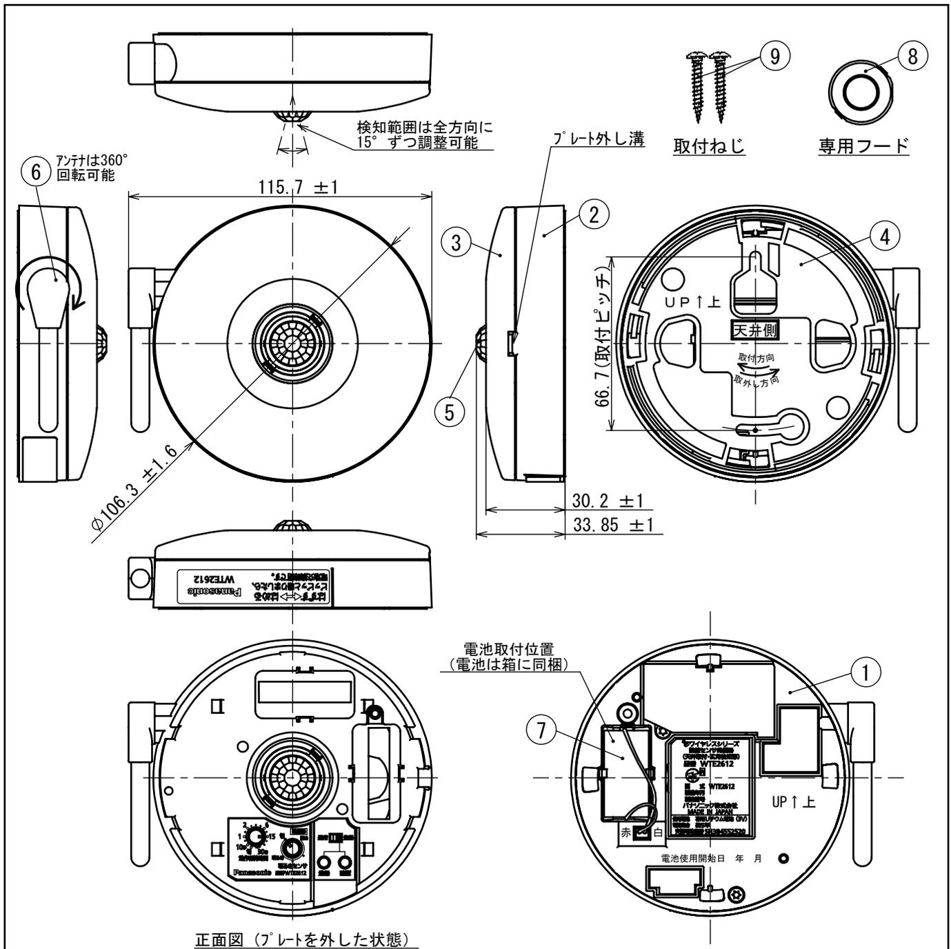
正面図 (プレートを外した状態)
