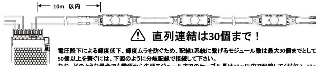
電圧降下による輝度低下、輝度ムラを防ぐため、配線1系統に繋げるモジュール数は最大30個までとしてください。50個以上を繋ぐには、下図のように分岐配線で接続して下さい。なお、どのような場合でも電源から先頭モジュールまでのケーブル長は10m以内で配線してください。10m以上の長さになる場合は弊社までお問い合わせください。
